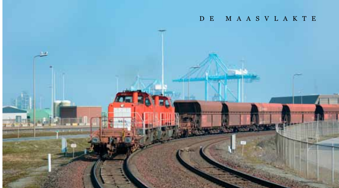
De ertstrein van EMO op de Maasvlakte naar Dillingen is de enige in ons land met automatische koppeling. Tussen EMO en de Maasvlakte zijn koppelwagens nodig. Op 11 maart 2016 komen de 6435 en 6423 vanaf EMO en naderen emplacement Maasvlakte. Frank Schouten
