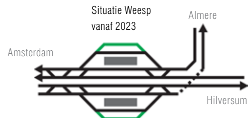
Voorstel: vier doorgaande sporen, waarvan de twee buitenste (groen) geschikt zijn voor 200 km/uur.
